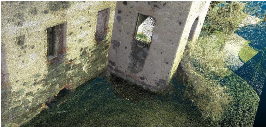
Bild 4. Kombination mellan lasermätt punktmoln och punktmoln från bildbehandlingsprocess.
